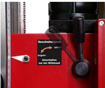
Schalthebel zum Einstellen des Drehzahlbereiches.
