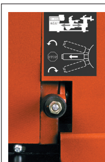
Schalthebel für Vorschubrichtung
